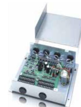
Rozměry V 80 x Š 290 x H 260 mm Napájení Jednofázové 100/200 V (50/60 Hz), 18 W Vstup Zapnutí/vypnutí skupiny (bezpečový kontakt/DC 24 V, impulzní signál), Chlazení/topení (bezpečový kontakt/statický signál), Požadavek 1/2 (bezpečový kontakt/statický signál) (lokální stop vypnutí) Výstup Provozní výstup (bezpečový kontakt), Výstup alarmu (bezpečový kontakt) Délka kabeláže Provozní vedení vnitřních/venkovních jednotek: celková délka 1 km. Digitální signál: 100 m nebo méně
